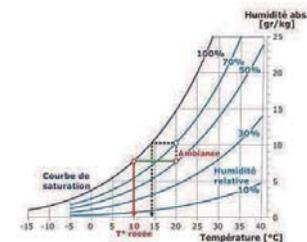
Exemple de représentation sur le diagramme de l'air humide.
